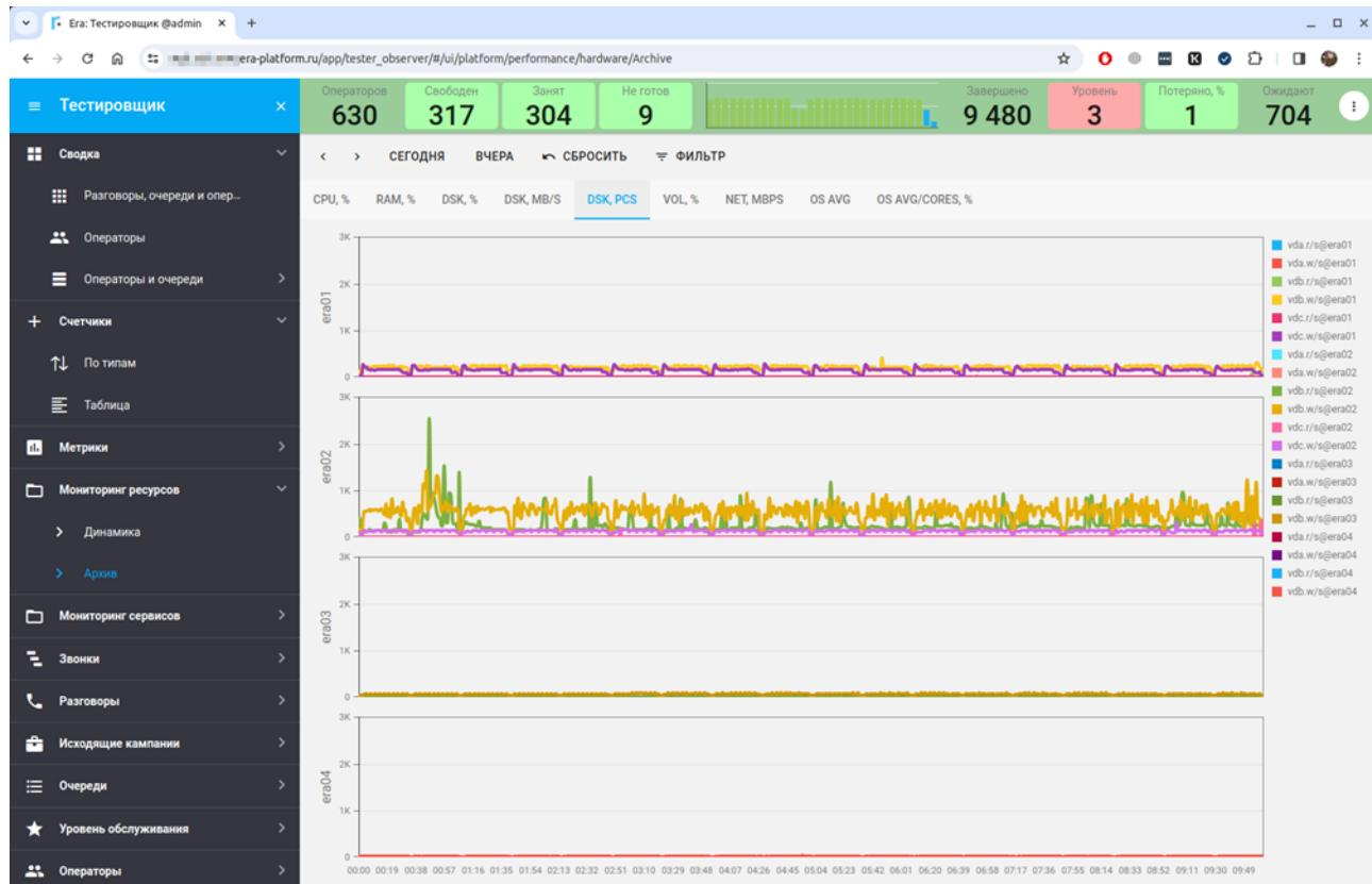
Наблюдаются характерные получасовые периоды интенсивной работы системы, связанные с активностью исходящей кампании плотностью 80 вызовов в секунду.
