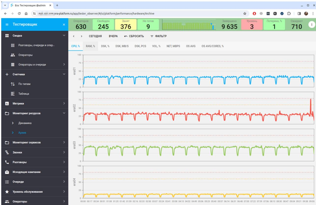
Наблюдаются характерные получасовые периоды интенсивной работы системы, связанные с активностью исходящей кампании плотностью 80 вызовов в секунду. Точечный всплеск на втором сервере связан с обращениями к отчетности в СУБД PostgreSQL.
